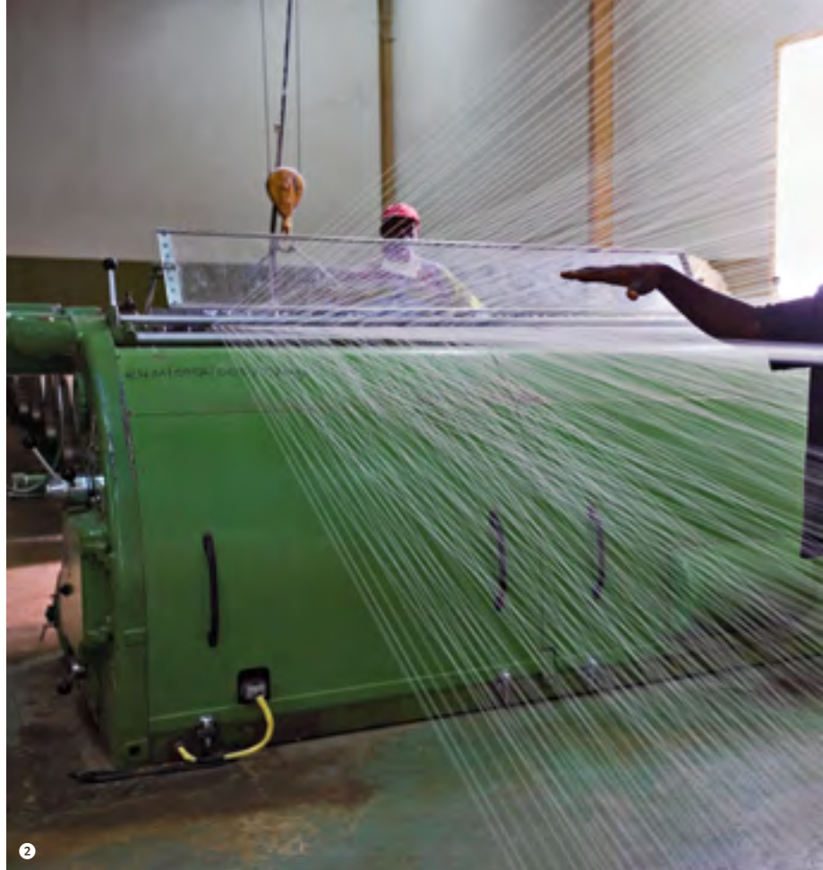
❶ Noch auf dem Feld wird die Baumwolle vorsortiert. ❷ In der Spinnerei entstehen aus den Baumwollknäueln meterlange Fäden. Lauf und Qualität werden während des Spinnvorgangs ständig überprüft. ❸ Auf Rollen aufgespult ist die Baumwolle fertig für die Weiterverarbeitung in der Weberei.
