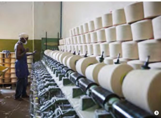
❶ Noch auf dem Feld wird die Baumwolle vorsortiert. ❷ In der Spinnerei entstehen aus den Baumwollknäueln meterlange Fäden. Lauf und Qualität werden während des Spinnvorgangs ständig überprüft. ❸ Auf Rollen aufgespult ist die Baumwolle fertig für die Weiterverarbeitung in der Weberei.
