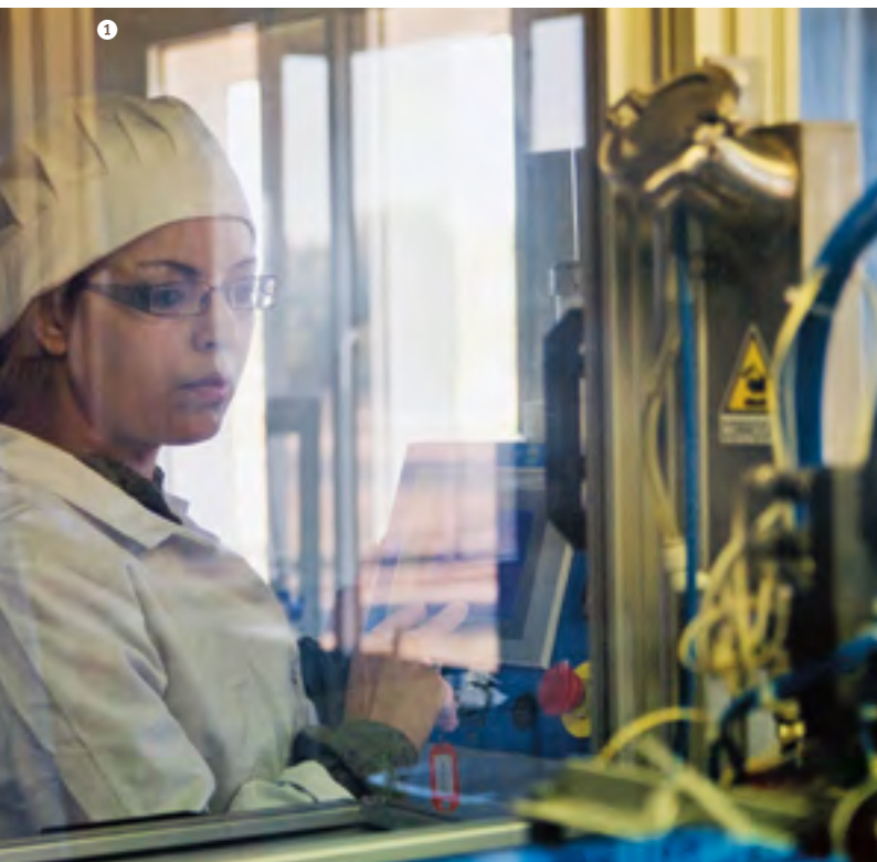
1 Am Stringer steuert und überwacht eine Mitarbeiterin die Verschaltung der einzelnen Solarzellen mit Leitungsbändern. 2 Eine Grundschule bei Ifrane hat ihr Kraftwerk auf dem Dach. 3 Windpark bei Essaouira
