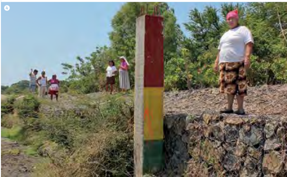
❶ Dieses Modellhäuschen wurde auf Stelzen gebaut – eine einfache Möglichkeit, Häuser vor Hochwasser zu schützen. ❷ Überall im Gemeindegebiet stehen Lautsprechermasten. ❸ Mit Hilfe der Lautsprecheranlage können Warnungen schnell durchgegeben werden. ❹ Pegel im Río Jiboa: Erreicht der Fluss den roten Bereich, wird es gefährlich.
